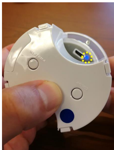
電源 LED の点滅を確認！
